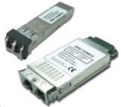
Multimode Extender SFP (oben) , GBIC (unten)
